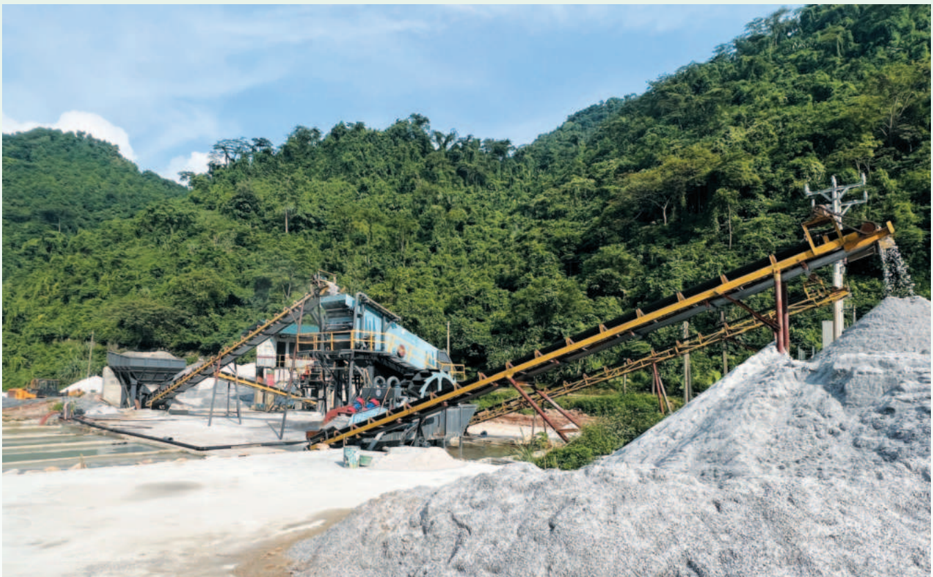
Dây chuyền nghiền cát nhân tạo công suất 50 tấn/giờ của Công ty TNHH MTV khoáng sản và thương mại Đồng Nam
